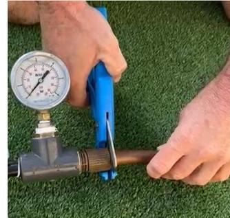
Pour changer de modèle de raccord couper au raz de la sortie le tuyau goutte à goutte.
