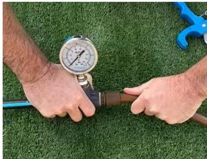
1 - Dévissez sur un tour le raccord et ensuite enfoncez le tuyau goutte à goutte puis resserrez l'écrou jusqu'à la butée.
