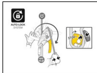
Le système AUTO-LOCK permet de se positionner facilement au poste de travail, sans avoir à manipuler la poignée et à réaliser de clé d'arrêt : dès que l'utilisateur relâche la poignée, la corde est automatiquement bloquée dans l'appareil.
