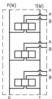
Schéma hydraulique en série
