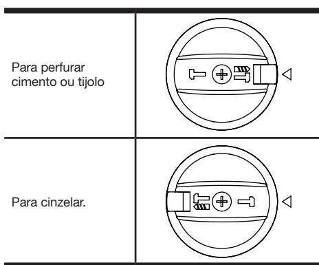
**Aviso:** O comutador de tipos de funcionamento só deve ser accionado quando o aparelho estiver parado.
