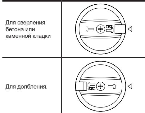
**ПРЕДУПРЕЖДЕНИЕ: Переключатель режима работы может быть приведен в действие только в состоянии покоя.**
