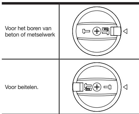
**WAARSCHUWING:** De werkingskeuzeschakelaar kan alleen in stilstand worden gebruikt.
