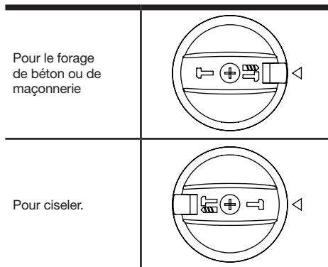
**AVERTISSEMENT : Le sélecteur de mode de fonctionnement ne peut être actionné qu'à l'arrêt de la machine.**
