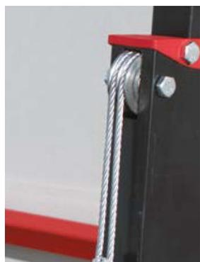
Élévation simultanée des 2 mâts = plus grande vitesse de montée (12 tours de treuil pour 1 m d'élévation)
