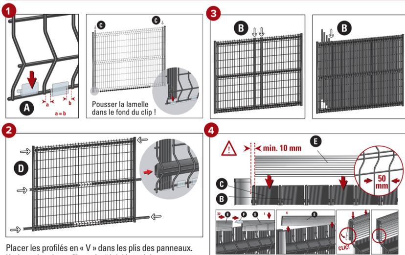
Placer les profilés en « V » dans les plis des panneaux.
