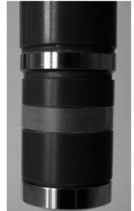
Remettre en place la bague de silicone afin de garantir l'étanchéité au niveau de l'évent et rincer à l'eau l'excédent d'électrolyte présent sur la sonde (*notamment s'il venait à y en avoir sur la membrane*).
