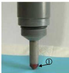
Sécher la sonde à l'air libre ou avec un chiffon sec, puis Vérifier si à l'extrémité de la pointe il a présence de résidus minéraux.
