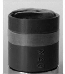
Revisser doucement le réservoir en vérifiant que l'évent soit bien débouché de façon à ce que l'excès d'électrolyte puisse s'échapper sans faire augmenter la pression à l'intérieur du réservoir,
