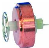
Passer à la toile émeri ou avec une brosse métallique souple l'électrode de cuivre et de platine,
