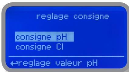
Le mode Proportionnel prévoit la configuration, dans l'appareil, du taux de fonctionnement calculé entre deux valeurs qui activent ou désactivent la pompe du pH.
