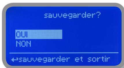
Pour terminer la procédure, sélectionner « OK » puis presser le bouton. L'appareil demandera s'il faut sauvegarder («Sauvegarder») les configurations. Presser "OUI" pour les sauvegarder ou «NON» pour ne pas les sauvegarder.
