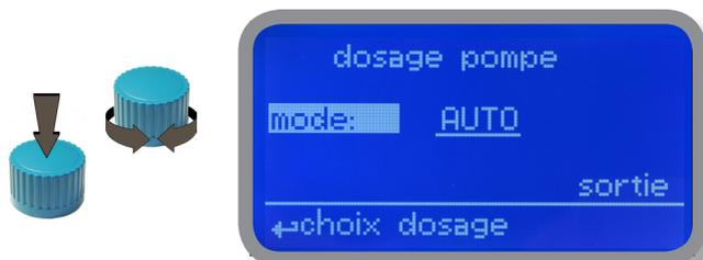
Amener le curseur sur "Mode" et appuyer pour sélectionner. Choisir "Man. Pump1" pour la pompe pH ou "Man. Pump2" pour la pompe du Chlore.
