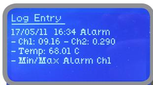
**Régler la date / heure avant d'activer log - Si ce n'est pas alimenté pendant de 30 jours, l'instrument réinitialiser la date et l'heure**
