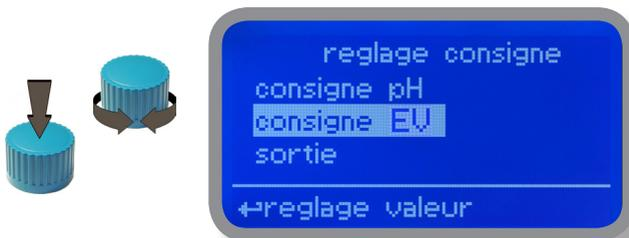
Le mode de fonctionnement On/Off prévoit la configuration, dans l'appareil, de deux valeurs qui activent ou désactivent la sortie EV de chlore. Pour sélectionner ce mode de fonctionnement, mettre en surbrillance "Working Mode" avec le curseur. Presser le bouton pour sélectionner.
