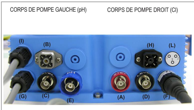
utiliser capuchons en caoutchouc pour protéger les sorties non utilisées
