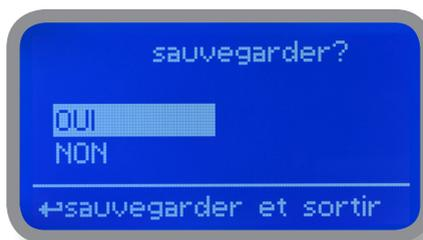
Pour terminer la procédure, sélectionner « OK » puis presser le bouton. L'appareil demandera s'il faut sauvegarder («Sauvegarder») les configurations. Presser "OUI" pour les sauvegarder ou «NON» pour ne pas les sauvegarder.
