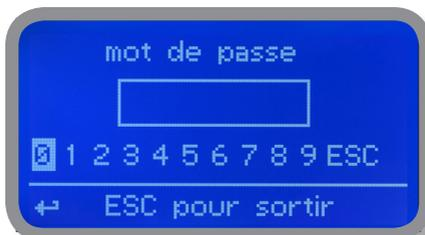
Pour configurer un nouveau mot de passe, sélectionner « Parametres » dans « Menu principal », mettre en surbrillance « Mot de passe », enclencher le bouton et saisir 4 chiffres. Sélectionner "EXIT" et répondre "OUI" pour sauvegarder. Maintenant, le nouveau mot de passe est activé.
