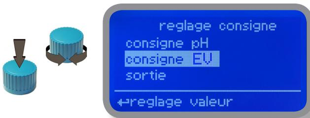
Le mode Proportionnel prévoit la configuration, dans l'appareil, du taux de fonctionnement calculé entre deux valeurs qui activent ou désactivent la sortie EV de chlore. Pour sélectionner ce mode de fonctionnement, mettre en surbrillance « Working Mode » à l'aide du curseur. Presser le bouton pour sélectionner.
