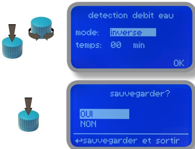
Pour terminer la procédure, sélectionner « OK » et enclencher le bouton. L'appareil invitera à enregistrer (« Sauvegarder ») les réglages. Appuyer sur « OUI » ou sur « NON » pour effectuer ou non l'enregistrement.
