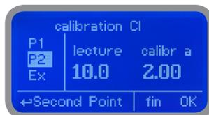
**Attention :** cette procédure suppose que l'appareil est correctement configuré, qu'il est raccordé à une sonde de chlore en parfait état et qu'il est monté sur le système. La mesure doit être prise en utilisant l'eau de l'installation. Autrement, les résultats pourraient ne pas être fiables.
