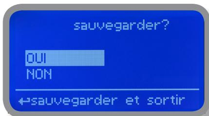
Choisir "OUI" pour enregistrer. Quitter le menu. L'écran principal affichera un compte à rebours pour la pompe sélectionnée (à gauche pour la pompe pH, à droite pour la pompe du Redox). Pour bloquer le compte à rebours, revenir au menu "Pump activity" et sélectionner "ON" comme mode de fonctionnement ou bien attendre la fin du décompte. *Cette fonction peut être utilisée pour l'amorçage.*
