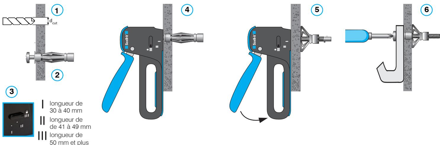
1 Percer le support au diamètre "d<sub>cut</sub>" indiqué.
