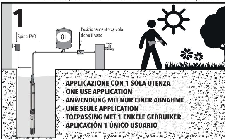
L'elettropompa Plug&GO NON deve essere, in nessun caso, utilizzata con il convertitore di frequenza.
