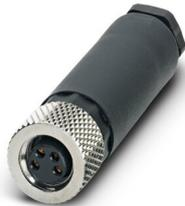
Connecteur, Universel, 4-pôles, connecteur femelle droit M8, détrompage A, Raccordement vissé, matériau de la molette: laiton, nickelé, diamètre extérieur du câble 3,5 mm ... 5 mm
