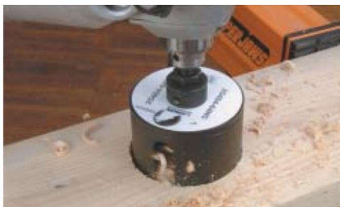
***Le trépan pour le bois Lenox One Tooth<sup>®</sup> a une conception brevetée permettant de couper 3 fois plus vite qu'un trépan traditionnel. Réaffutable.***
