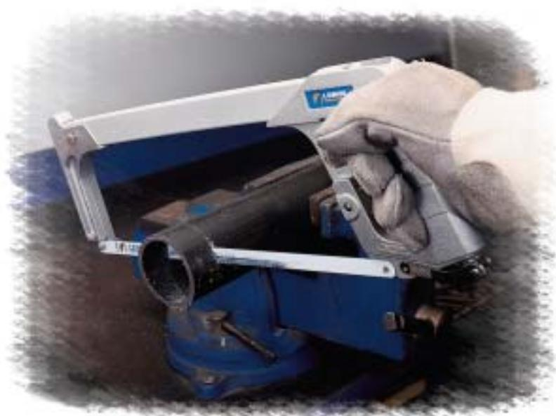
1. Le levier tend la lame de la scie à métaux de 300mm (12") à 21 kg/mm<sup>2</sup> (30.000 psi), environ deux fois plus que les montures ordinaires.
