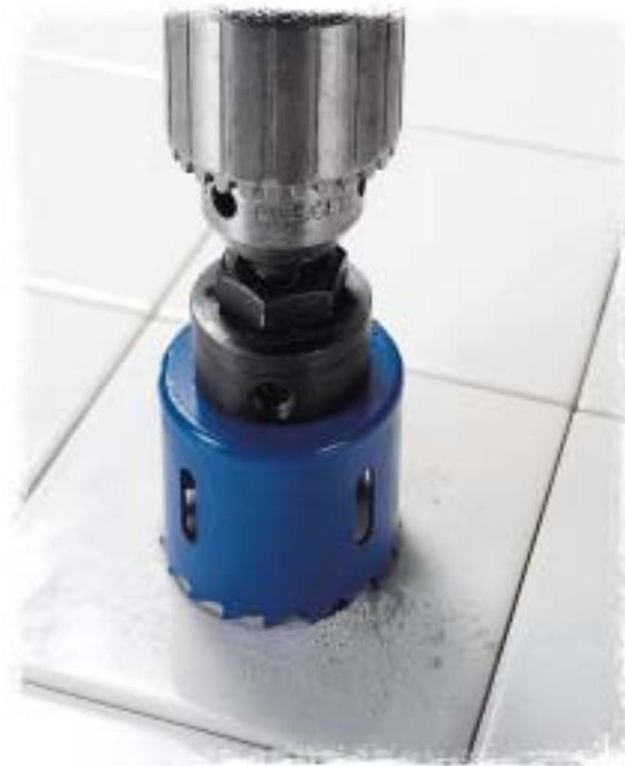
Remarque : Les scies trépan à plaquettes de carbure utilisent des arbres standard. Cependant, nous recommandons l'utilisation d'une mèche pilote à plaquettes de carbure lors de l'usage d'une scie trépan à plaquettes de carbure montrée ici en train de découper un carreau de céramique sur un mur. La mèche pilote 123CT s'adapte aux arbres 1L, 1SL, 2L, 2SL, 4L ou 7L. La mèche pilote 65CTPD s'adapte aux arbres 5L, 6L.
