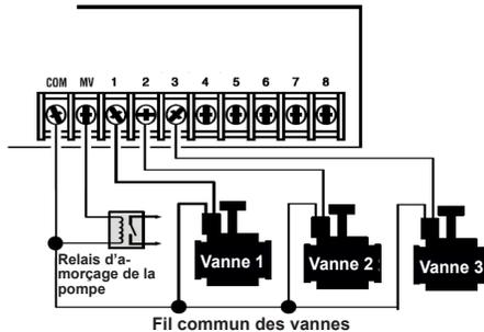
**⚠ MISE EN GARDE :** Pour éviter que la pompe ne soit endommagée par le « point mort », connecter un fil de liaison depuis toute borne inutilisée sur la station à une borne auquel une vanne est connectée. Voir **Figure 3**.
