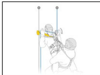
L'ASAP'SORBER AXESS peut être utilisé jusqu'à 250 kg dans le cadre d'un secours à deux personnes.
