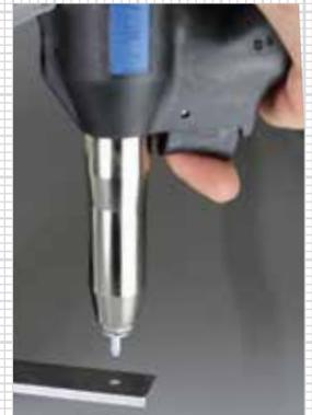
Le flux d'air maintient le rivet aveugle non posé de manière sûre dans le nez de pose quelle que soit la position – laissant ainsi une main libre pour positionner le composant.
