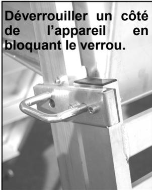
Déverrouiller l'autre côté en maintenant une pression avec le pouce.
