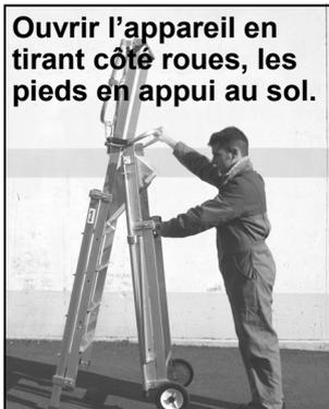
Ouvrir l'appareil en tirant côté roues, les pieds en appui au sol.
