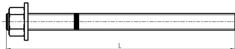
**Tiges filetées commerciales standards M8 à M30** avec marquage identifiant le fabricant et la profondeur de scellement: acier galvanisé au carbone de classe 5.8 à 10.9, Acier inoxydable A4 et HCR.
