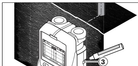
Pour le traçage exact de l'objet sur le mur, déplacez l'appareil de mesure vers la gauche ou vers la droite jusqu'à ce que l'objet détecté se trouve en-dessous d'un bord extérieur. Si, p.ex. l'objet détecté est affiché sur l'affichage **16** au centre en-dessous de la ligne droite pointillée **g**, il est possible de le tracer de manière précise sur le repère de droite **3**.
