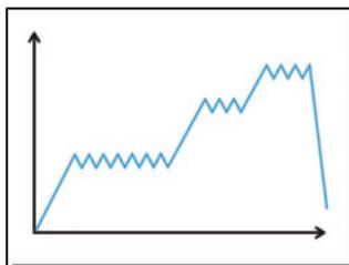
En cas de chute, le déchirement de la sangle de l'absorbeur d'énergie limite la force de choc subie par l'utilisateur. Les longes sont destinées à des utilisateurs dont le poids est compris entre 50 et 140 kg. Le déchirement de la sangle se fait par paliers, afin de limiter la décélération subie par les faibles poids.
