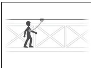
La longe à simple brin ABSORBICA®-I VARIO permet de s'assurer, en particulier sur une ligne de vie horizontale ou sur une plateforme élévatrice, sans passage de fractionnement.
