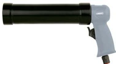
Pistolet à cartouche pour cartouches en plastique standard de 310ml. Multi-usage peut être utilisé pour le silicone et les colles. Décharge rapide de la pression en poussant la vanne de désaération. Scellement rapide et facile sans efforts manuels.
