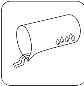
Lavez un tube pour échantillon adéquat **avec un peu d'échantillon et videz-le en laissant quelques gouttes.**
