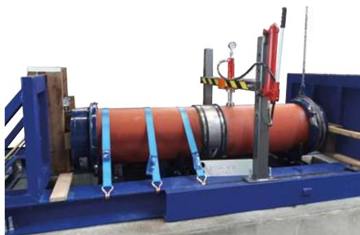
Essais de résistance au cisaillement d'un raccord FLEX-SEAL Plus® SC445. Le même type de test est appliqué à tous les raccords de la gamme FLEX-SEAL Plus®.
