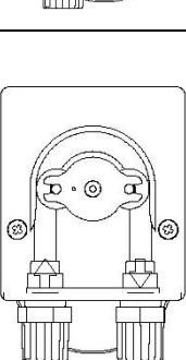
**FR** Insérer le raccord de droite dans l'encoche prévue. Positionner le couvercle sur la pompe et le fixer à l'aide des deux vis.
