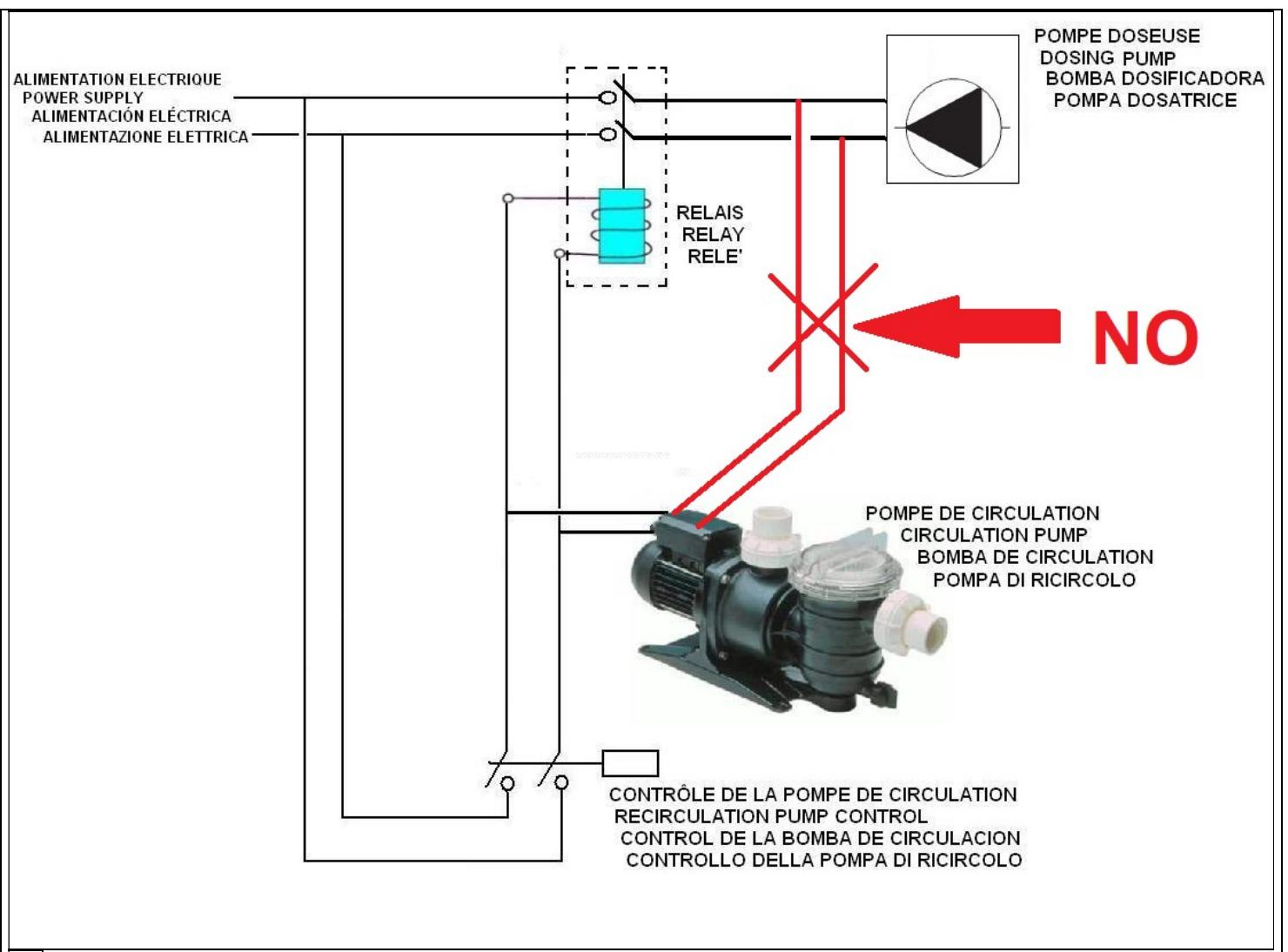
**IT** ! ATTENZIONE! La pompa deve iniettare quando l'acqua scorre attraverso l'impianto di filtrazione. Verificare che i valori di targa di alimentazione elettrica corrispondano a quelli dell'impianto. Per non danneggiare la scheda elettronica non collegare l'alimentazione elettrica direttamente in parallelo all'alimentazione elettrica della pompa di ricircolo ma utilizzare sempre un teleruttore/relè. L'avvenuta accensione della pompa è confermata dall'accensione del display.
