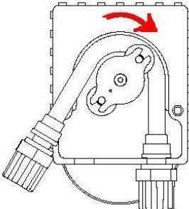
**FR** Enlever le couvercle transparent en dévissant les deux vis. Enlever le vieux tube en débloquant d'abord le raccord de gauche. Faire tourner le porte-galet dans le sens de la flèche jusqu'au raccord de droite afin de libérer le tube péristaltique.
