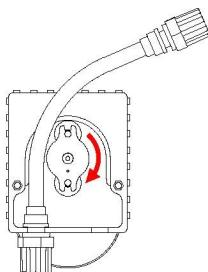
**FR** Positionner le raccord de gauche du nouveau tube péristaltique dans l'encoche prévue à cet effet. Faire attention à ce que la partie arrondie soit orientée vers l'intérieur. Tourner le porte-galet dans le sens horaire de façon à ce que le tube péristaltique se mette naturellement en place. Ne jamais tourner à contre-sens.
